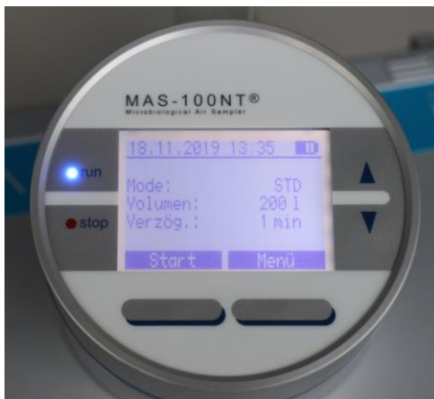
Abbildung 2: Geräteeinstellungen der MAS-100 NT 6022 Luftkeimsammler für die Beprobung von 200 Liter Raumluft. Es wurde mit einer Verzögerung von 1 Minute gearbeitet, um keine Luftverwirbelungen zu produzieren.
