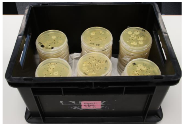
Abbildung 3: Aufbewahrung der 72 beprobten Nährmedien: Nach 4 Tagen Inkubation bei Raumtemperatur wurden die Nährmedien auf einem Leuchttisch ausgezählt
