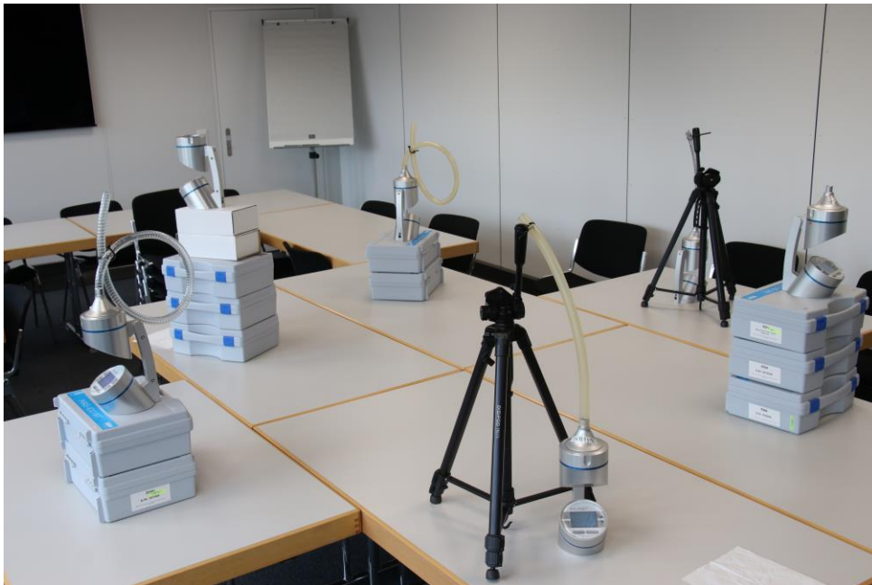
Abbildung 1: Messaufbau zur Erprobung der Auswirkung der Verwendung eines Schlauchadapters mit Schlauch während der Luftkeimmessung: Sechs Messgeräte wurden mit identischem Abstand von 1 Meter in einem Kreis angeordnet. Es wurde parallel in 2 Replikaten gemessen und der Versuch an einem zweiten Tag analog wiederholt.
